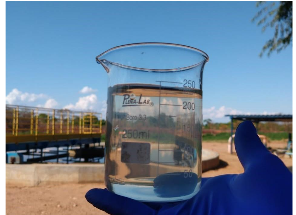
Saída do decantador
